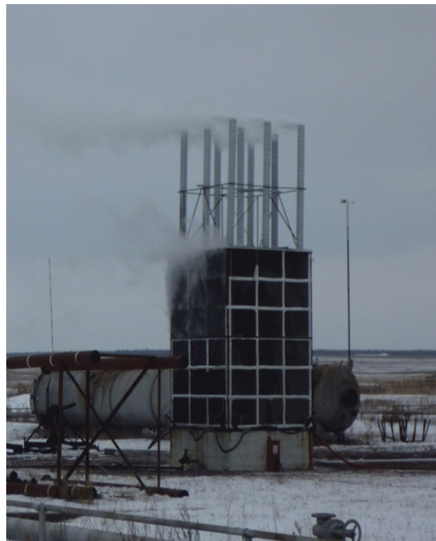
Рассеивание газа при его аварийной утечке
